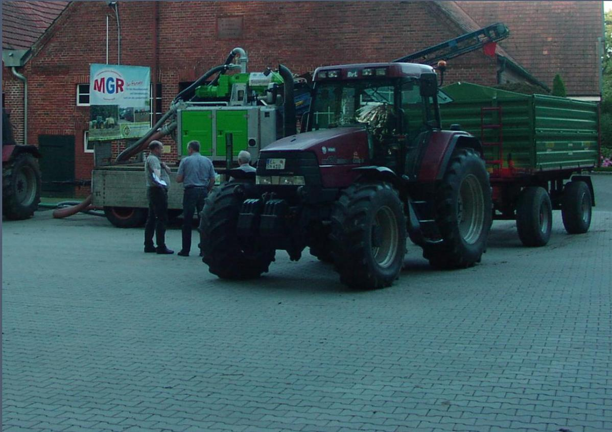
Separierung von Rindergülle mit einer Leistung von ca. 25m<sup>3</sup> /h und anschließendem Einsatz als Ersatz für Maissilage in einer Biogasanlage
