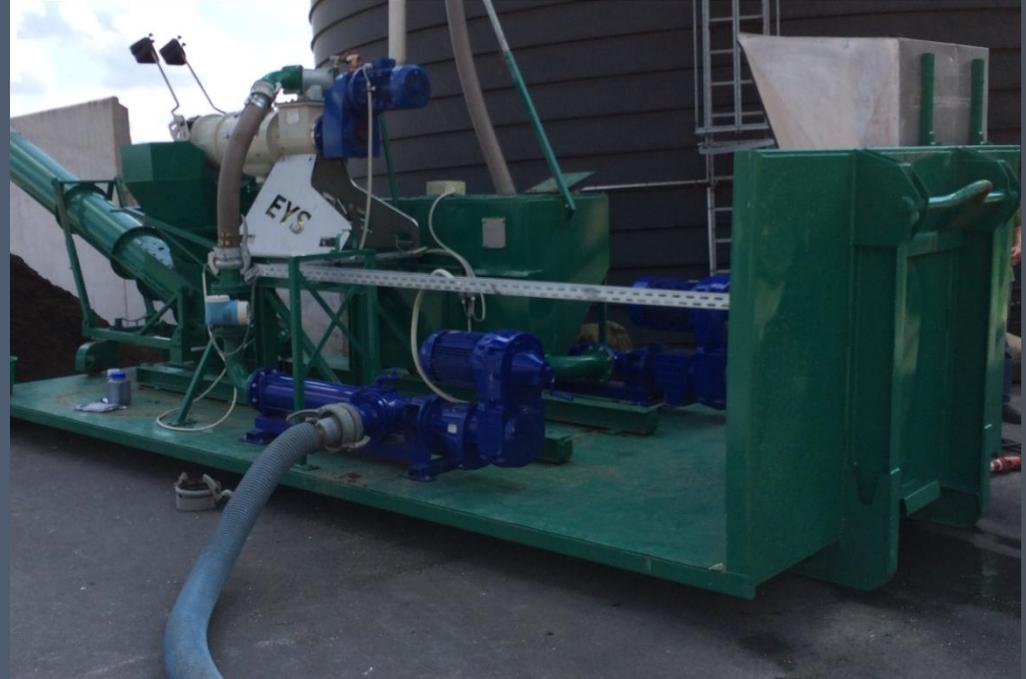
Separierung von Gärresten an der BGA Twenning mit der Pressschnecke von Huning (Einsatz von Rüben und einer nachgeschalteten Zerkleinerung für Gärsubstrat in der BGA).
